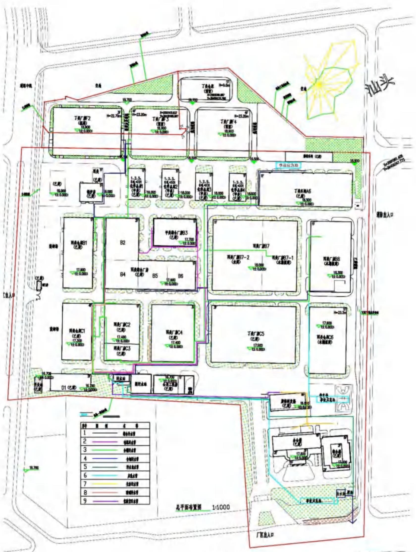
图 3.1-6 厂区污水管网走向图
